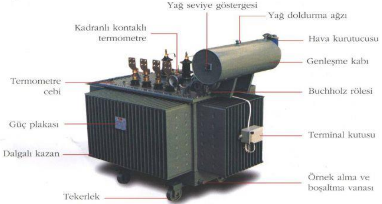
Şekil - 14 Dağıtım Transformatörü genel görüntü
