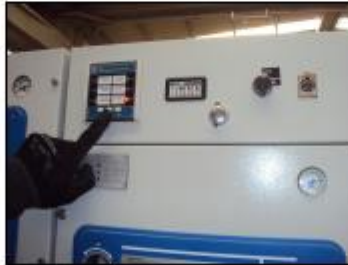
SİNYAL LAMBA KUTUSUNDA İKAZ LAMBALARI YANMIYORSA SİLME TUŞUNA BASARAK DURUMU SIFIRLAYINIZ VE İŞLEMİ TAMAMLAYINIZ.
